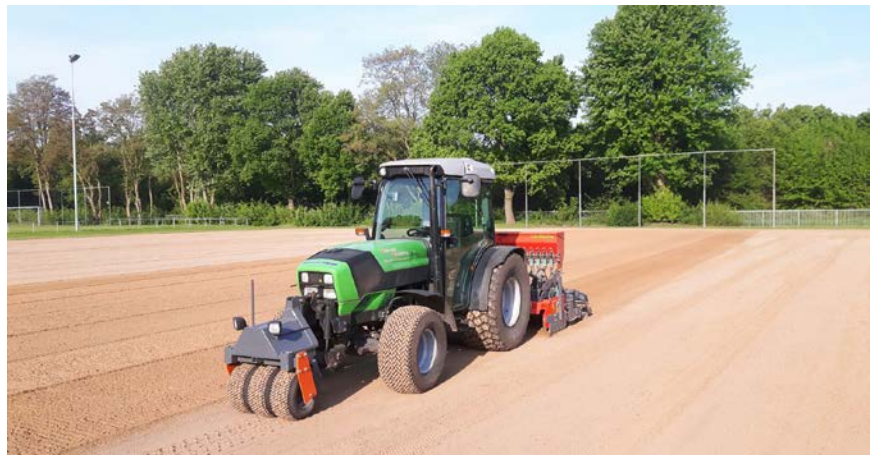
Machinaal inzaaien van een sportveld met een smalspoortrekker. De zaaimachine heeft luchtondersteuning voor de gewenste goede verdeling van het zaai. Denk aan het zaaien van bloemenmengsels in plantsoenen.
